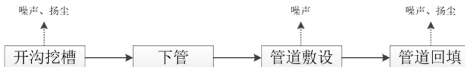
图 4-3 项目施工期管道敷设工艺流程图
