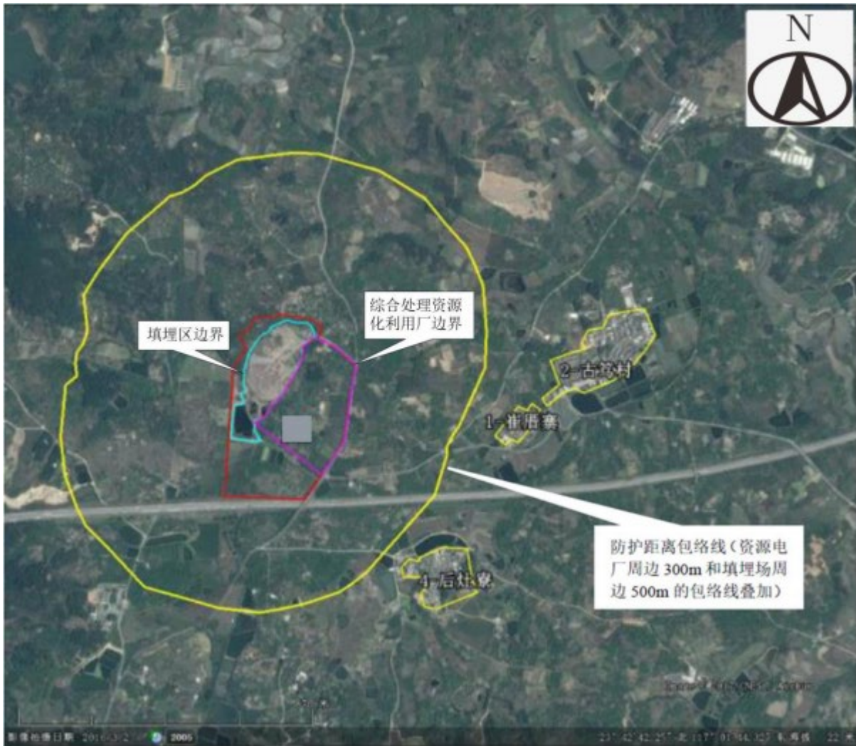
图2-6 本公司防护距离包络线图
