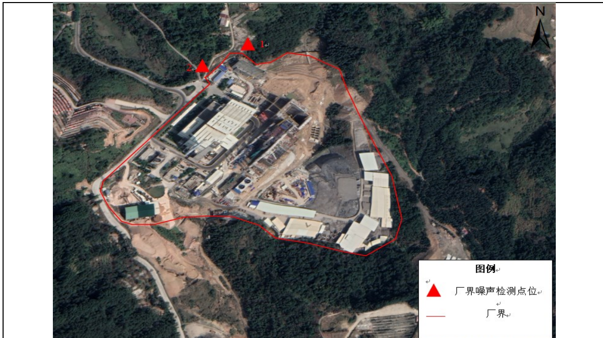
图 7-2 厂界噪声检测点位示意图
